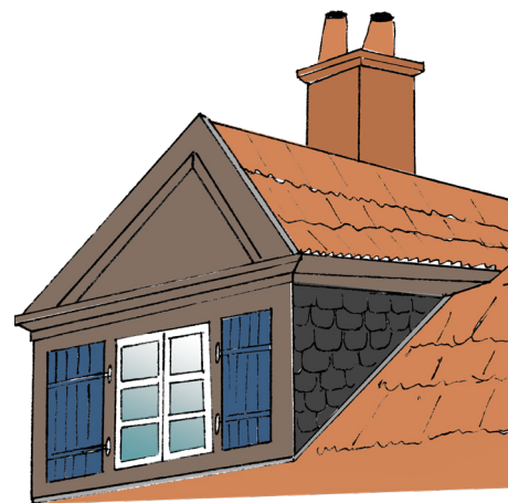
Lucarne à fronton triangulaire à une baie avec volets battants
